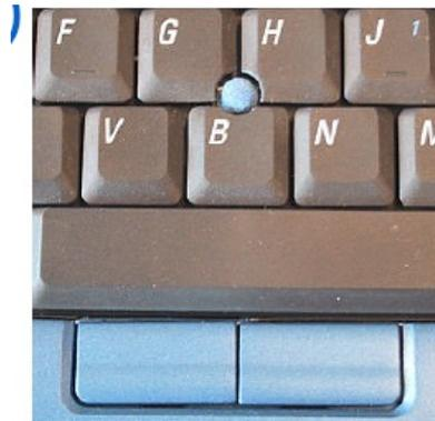
In Tastatur eines Laptops integrierter Stick, zugehörige Tasten unter der Leertaste
